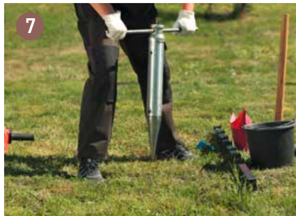
À l'aide du levier, tirez l'outil rapide avec un léger mouvement de rotation
