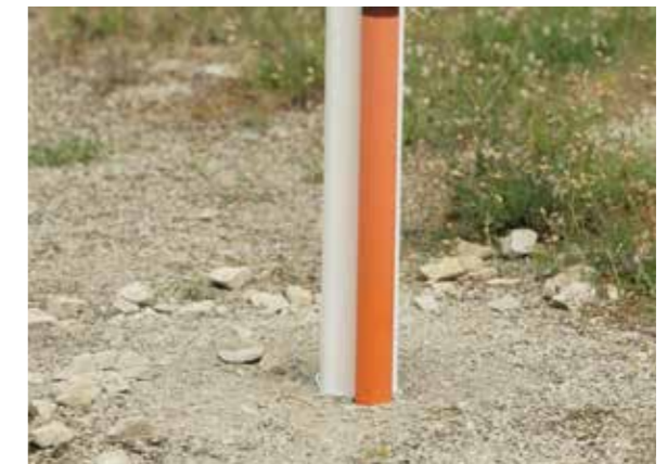
Support avec tige de neige insérée (couvercle retiré)
